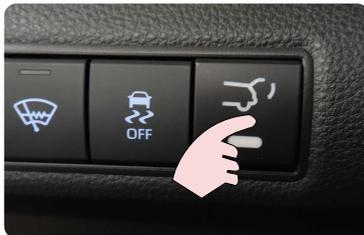
Schließetaster in der Heckklappe
