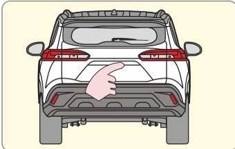
Taster in der Heckklappe
